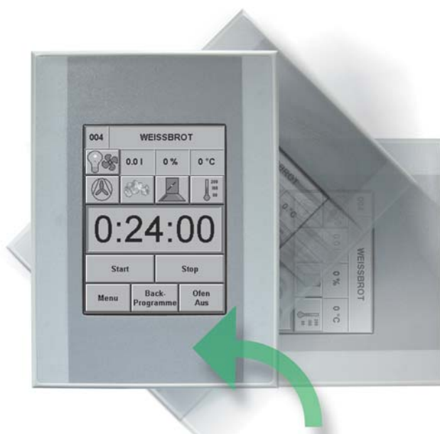
XV200: ЧМИ или ЧМИ-ПЛК со встроенными Ethernet и USB интерфейсами. Имеется три варианта с дополнительными интерфейсами RS232, CANopen или MPI.
