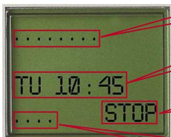
Отображение состояния входов – если на вход подан сигнал, то вместо точки отобразится номер соответствующего входа
